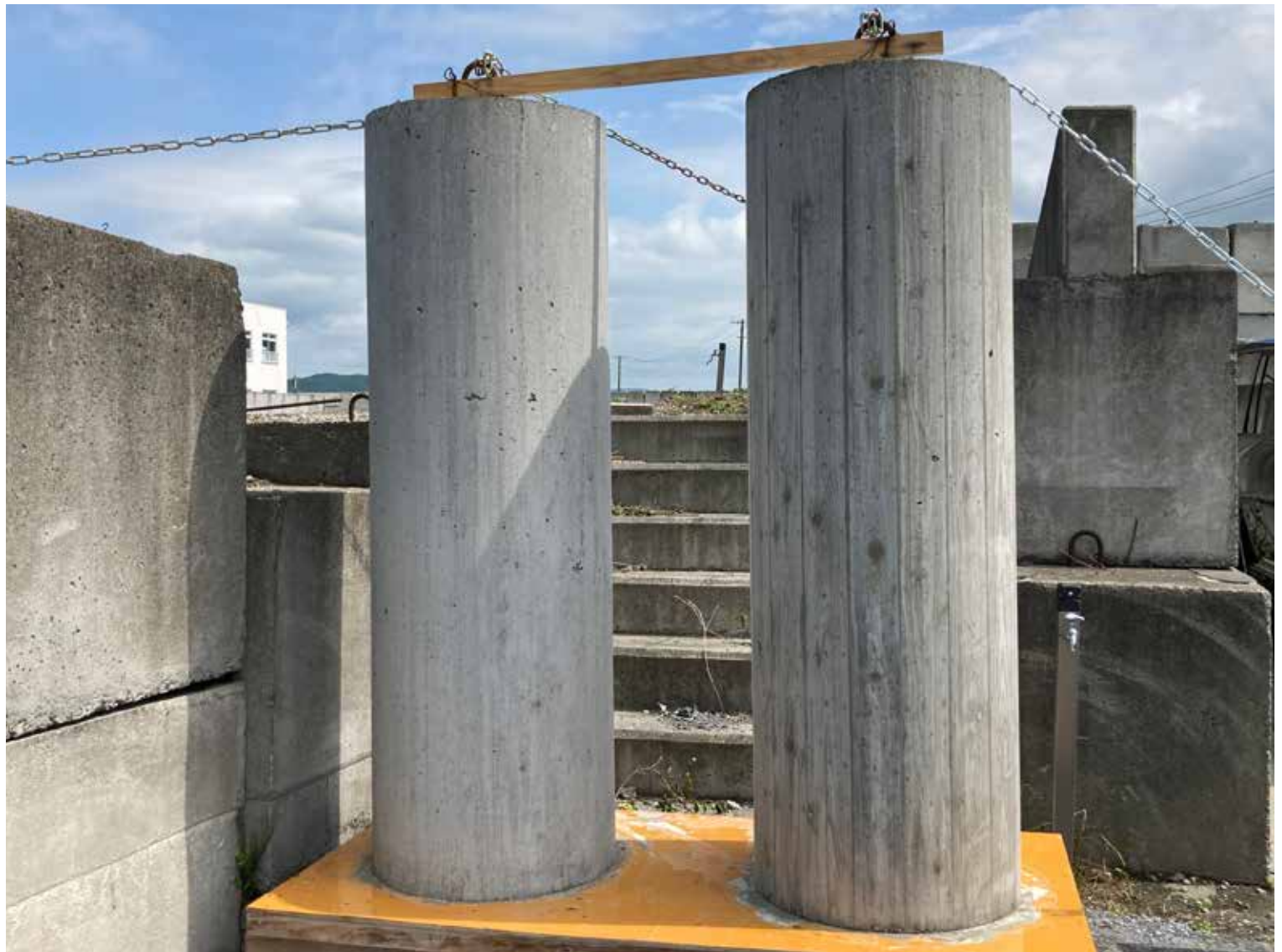
型枠の処理の違いによる表面の出来栄を確認した。
