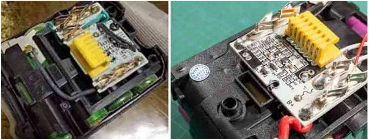
マキタ互換バッテリーのほとんどがマキタ初期型バッテリーのコピー基板を搭載しています。この互換保護基板は過電流保護や高負荷時の遮断機能が非搭載で、バッテリーが異常な状態になってもそれを検知して止める機能がありません。
